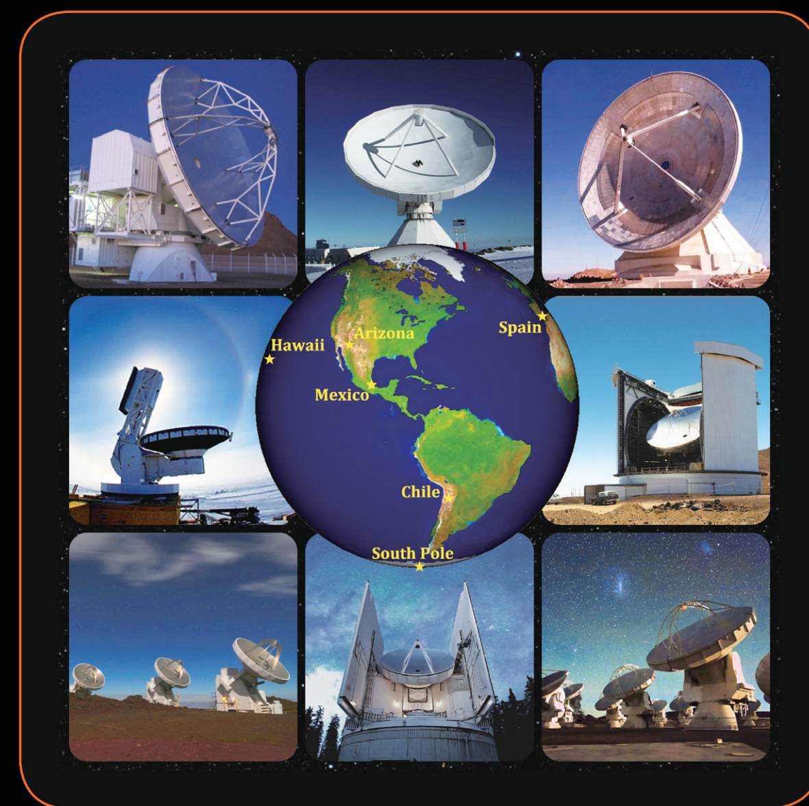
參與 2017 年銀河系中心人馬座 A 星觀測的電波望遠鏡，遍布於全球各地。這些望遠鏡成員利用特長基線干涉儀技術共同合作觀測，達到足以解析銀河系中心黑洞的角解析度。© Event Horizon Telescope Collaboration
